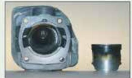
Les huiles 2 temps standard produisent des dépôts sur les pistons, ce qui provoque des dommages à températures élevées.
