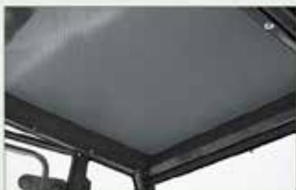
Le plafond comporte un matériau insonorisant permettant de réduire le niveau de bruit.
