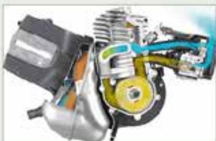
Le nouveau cylindre et le silencieux avec déflecteur intégré rendent la machine moins sensible aux conditions extérieures et aux variations de carburant.
